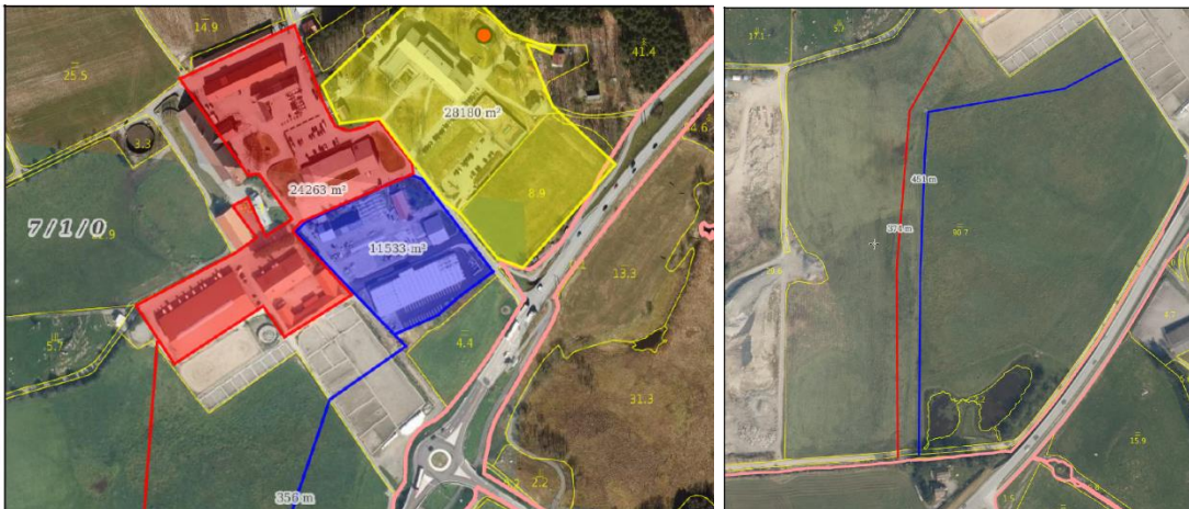
Figur 7: Føring av overvann på tomten - Bilde mottatt av drift
